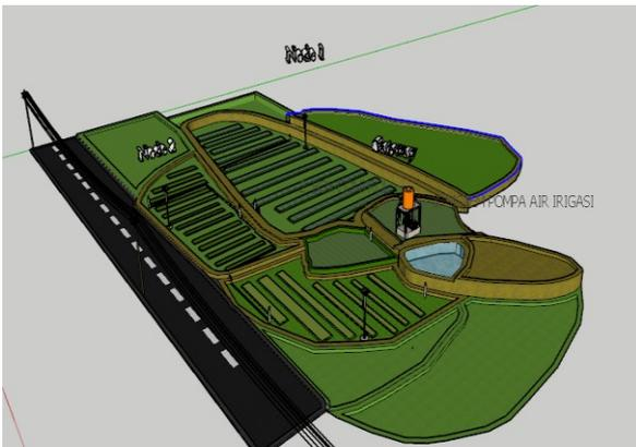
**Gambar 2a:** Skema disain penerapan sistem di lahan objek pengabdian. Pompa air irigasi dapat dipasang tepat di sebelah sumber air
