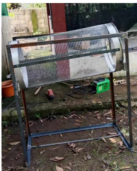
Gambar 12. Mesin pengayak maggot manual berbasis pedal
