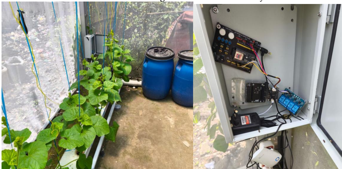
Gambar 3. Instalasi sistem IoT sensor otomatis pemberian nutrisi tanaman budidaya secara hidroponik
