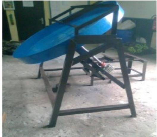
**Gambar 1.** Mesin granulator untuk pembuatan pupuk (Warji dkk, 2018)
