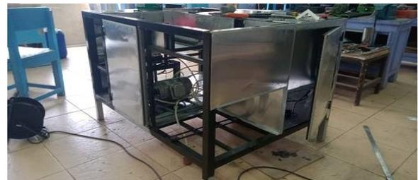
**Gambar 5:** Pemasangan penutup rangka
