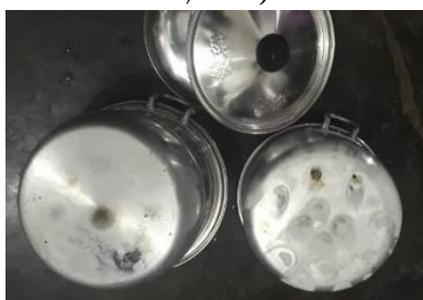
Gambar 8. Bagian bawah panci setelah digunakan selama  $\pm 3,5$  jam.
